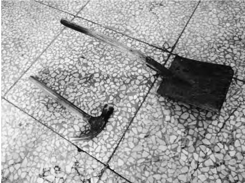
鉄製のスコップを灰かきにもちいている。柄は木製。
