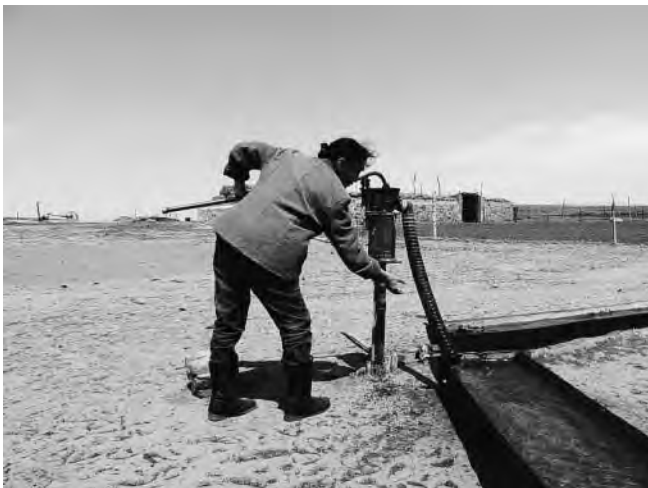
手押しポンプになり，汲みあげ用のバケツは使われていない。
