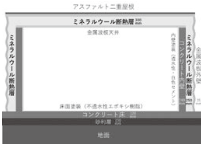
図2 ヴァイレ旧収蔵施設の構造模式図 (筆者作成)
