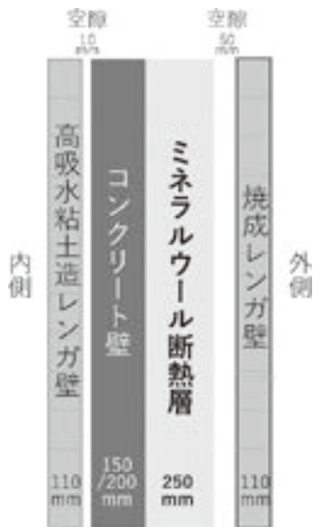
図4 リーベ収蔵施設壁構造の模式図 (筆者作成)
