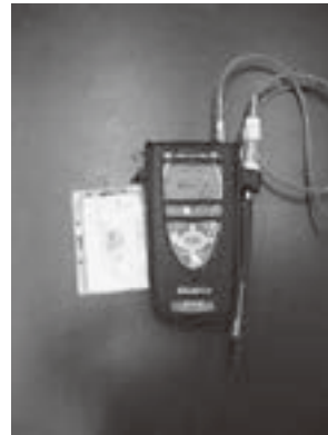
写真9 高濃度ガス検知器 (2004年4月20日 筆者撮影)
