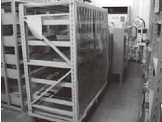
写真6 酢酸吸着フィルタ棚（簡易放散ユニット側からみたところ） （2011年9月22日 撮影：江田勝代）
