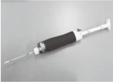
写真4 手動式ガス採取器を用いた検知管測定 (2021年8月27日 筆者撮影)
