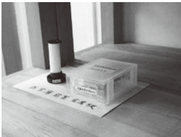
写真6 空気環境調査（左：トリエタノールアミン円筒ろ紙法、 右：金属板腐食調査）（撮影：宮内庁正倉院事務所）
