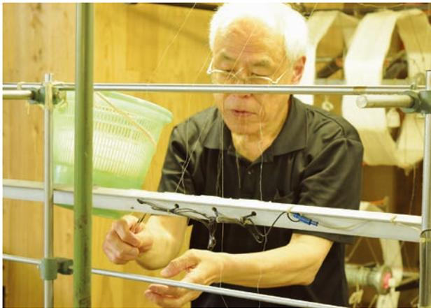
松井機業における、しけ絹を織るための玉糸の糸繰り作業。機械化されているものの、節の大きな部分が引っ掛かるため、つきっきりで切れた糸をつなぐ操作をしている。力織機もスピードが速すぎるものはこの糸に使用しないという。「手仕事」とは何かを改めて考えさせられた（2019年、富山県南砺市）。
