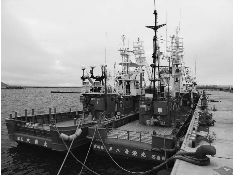
写真3 鮎川捕鯨の小型捕鯨船。小型捕鯨船は後部に鯨を解体する甲板を備えているのが特徴である。第三大勝丸(左)は2017年に新造され、小型捕鯨船では初めて鯨探機を装備している。(2017年8月、筆者撮影)
