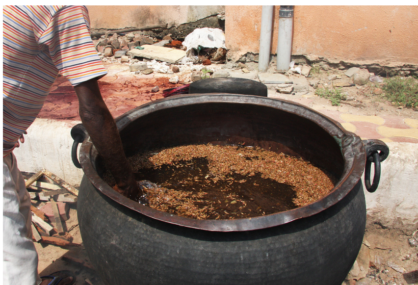
写真10 観賞用染色布の世帯によって共同で使用する大型の鍋。アリザリン染料と助剤のダヴァディの花を用いて染色をおこなう（2010年筆者撮影）。
