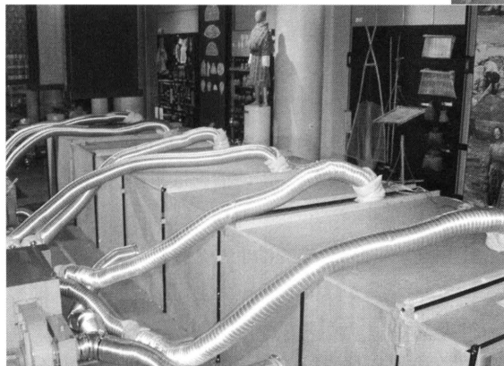
図2 可搬型組立式装置による展示場での大型木造漁船の高温処理(口絵カラー参照)
