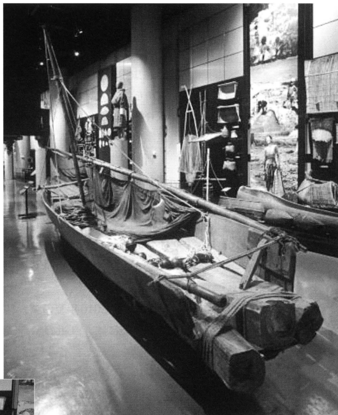
図2 可搬型組立式装置による展示場での大型木造漁船の高温処理(口絵カラー参照)
