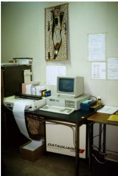
BAC事務室の奥に置かれたコンピュータには、UPS（無停電電源装置）が必須, 1989, 久保
