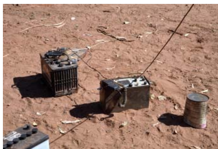
CB無線の電源は自動車バッテリー, イカラカル, 1989, 久保
