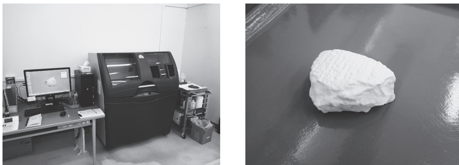
図 38 国立民族学博物館所有の 3D プリント “ProJet® 460Plus” [左] とプリントアウトした遺物サンプル [右] (2015 年 筆者撮影)
