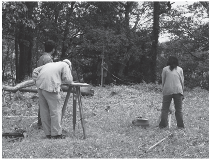
図4 平板測量の作業風景 (2005 年 筆者撮影)
