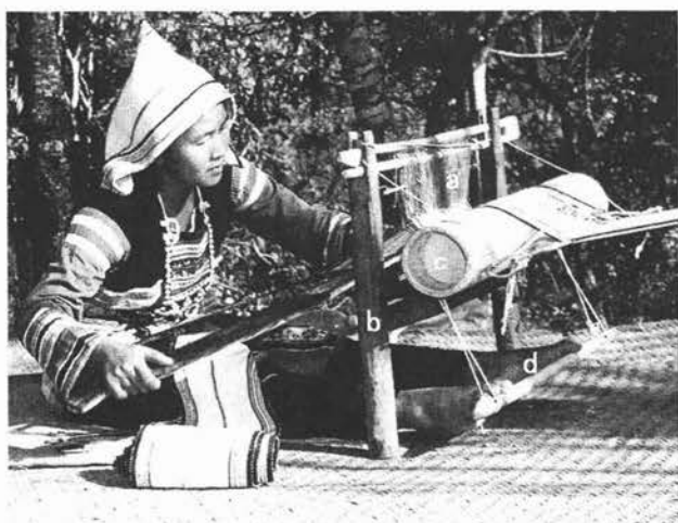
写真2 基諾族の単式輪状綜統型(綜統固定・開口保持具可動式)の開口具をともなった腰機による機織(中国、雲南省景洪県基諾郷:1995年) a-輪状綜統、b-綜統保持具、c-開口保持具、d-開口補助具(押さえ棒)
