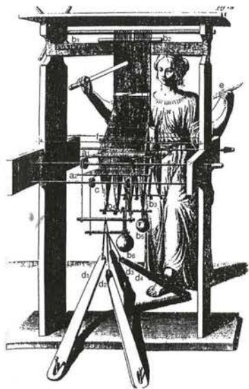
図4 “Vestibus Sacerdotum Hebraeorum”所収のJohannis Brauniusによって描かれた錘り機 (“Studies in Primitive Looms”より) a1~a2-番目綜統、b1~b4-タテ糸保持具 (b1-布巻き具)、b5~b6-錘り、c-滑車、d1~d4-踏み木、e-緯入具、f-箆
