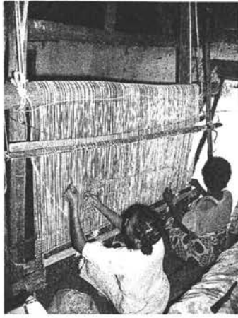
写真3 マハフアリ人の垂直式枠機による機織り(マダガスカル、アムバニヒ:1993年)
