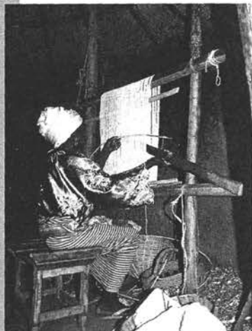
写真6 カブレ人の垂直式枠機による機織り（トーゴ、ランダ：2000年）
