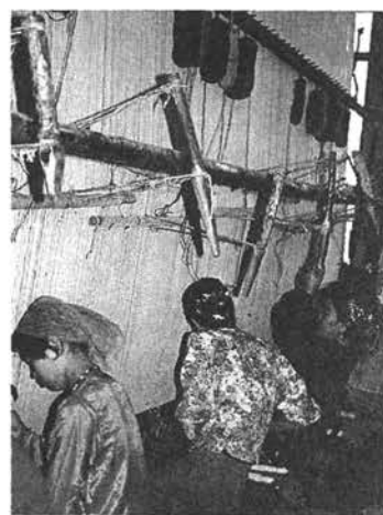
写真8 ウイグル人の垂直式枠機による機織り（中国、新疆ウイグル自治区、和田：1999年）
