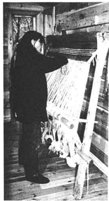
写真8 錘り機による機織り・1 (ノルウェー、マンダレン：1995年)
