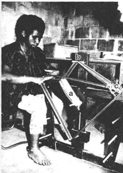
パプア人による輪状綜統機 (インクル・ルーム) による機織り (パプア・ニューギニア、ゴロカ: 1979年) a-輪状綜統、b-開口保持具 c-タテ糸の結節部分
