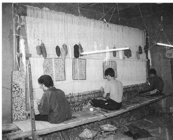
写真38 垂直式枠機【IFF-6】
