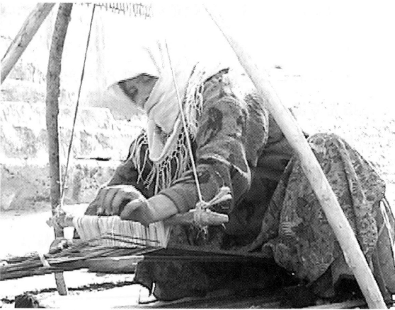
写真23 綜統・開口保持棒手動式による開口操作
