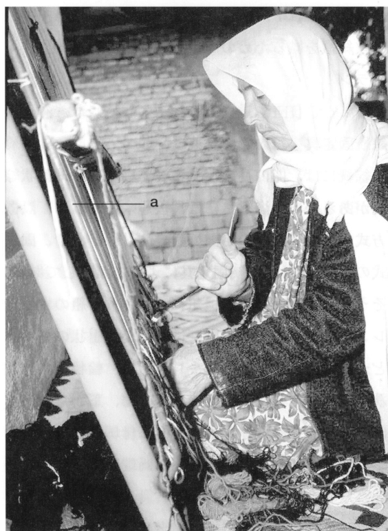
写真27 把手状の金具を使用した綜統固定具-a
