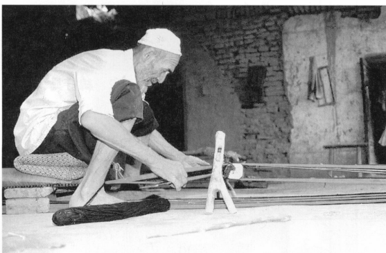
XGJ-1-3 開口保持棒を引き寄せると、上糸が上、下糸が下に押し開かれる
