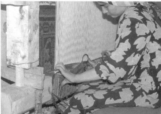
XFJ-1-5 鋏でパイル糸を切りそろえる
