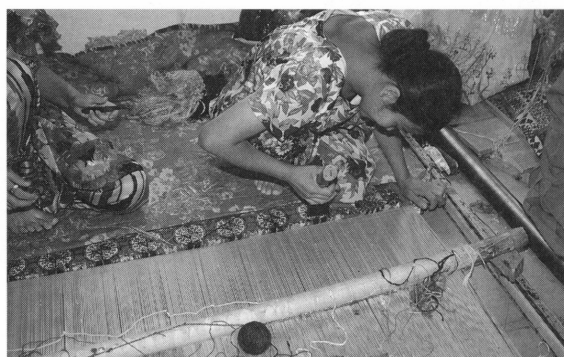
UFF-2-3 パイル糸の打ち込み
