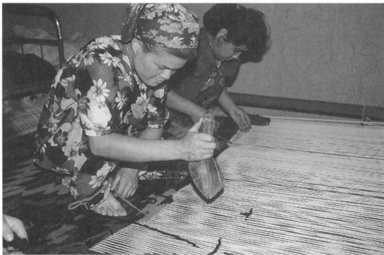
UFF-1-2 緯打具による緯糸の打ち込み
