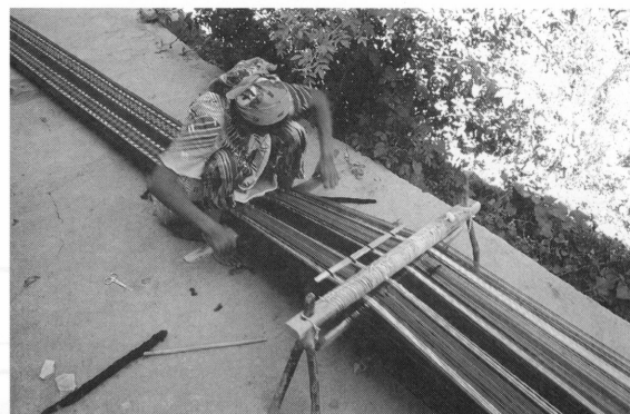
UGC-5-6 緯打具による緯糸の打ち込み
