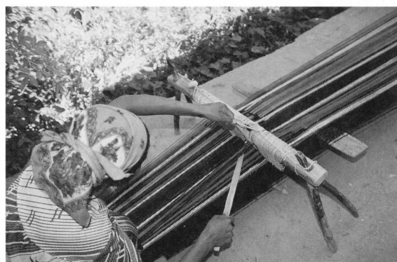
UGC-5-4 糸綜統で引き上げた経糸のあいだに 経糸すくい板を挿入する
