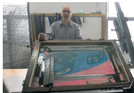
図8-3 写真製版・間接法 リカード氏の例 ⑤スクリーンに貼り付け、目止め剤を塗布 ⑥乾燥後、版を刷り台に取り付ける
