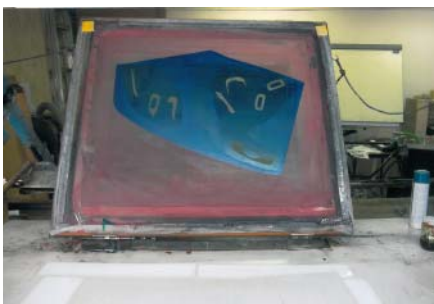
図8-3 写真製版・間接法 リカード氏の例 ⑤スクリーンに貼り付け、目止め剤を塗布 ⑥乾燥後、版を刷り台に取り付ける
