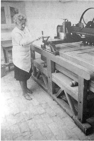
写真3 ハンドルを回して可動部分を移動させ、下にあるローラーを回転させる
