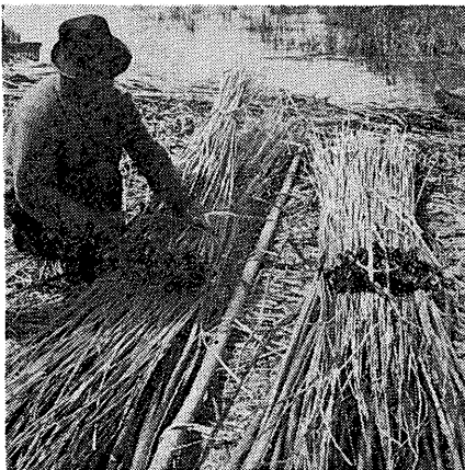
写真23 仮締めをして、トトラ束の太さを知る
