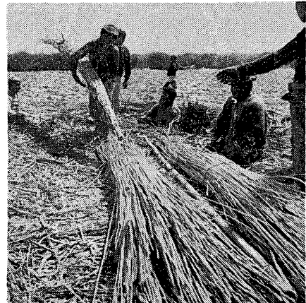
写真24 船体の長さにあわせて芯束をつくる
