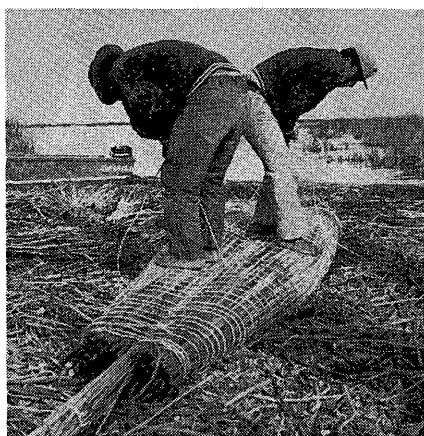
写真28 体重をかけ、さらに胴を締め上げる
