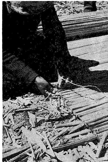
写真40 両端を縄で双子にとじる
