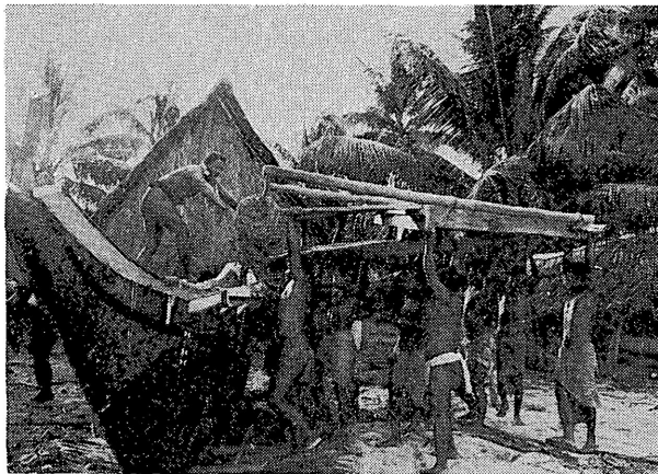
写真10 装着、とり外しが自由な風下側のプラットホーム。
