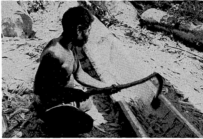
写真4 カヌーの船底部を手斧だけでくり抜く作業。
