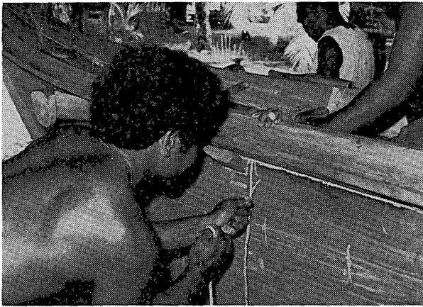
写真5 舷側板をパンノキの樹液ではり合わせる。
