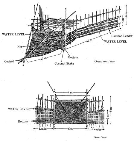
Figure 13. The Palopad Filter Bag Net
