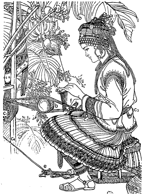
▲ 図85 Blccd 型機=哈尼族の手織機 [雲南省轻工局工艺美术公司 1976: 83]
