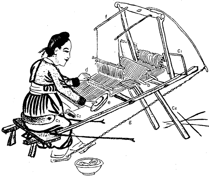
図82 Blccd 型機＝韓国の手織機 [Broudy 1974: 114, Fig. 6-14]
