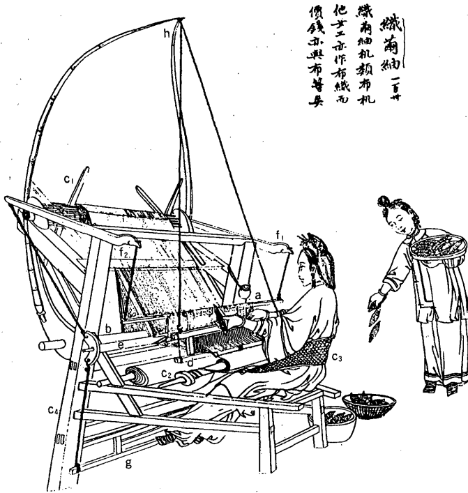
図94 B1dcd 型機に該当する中国の“織繭紉機”の絵画資料 [KUNH 1975: 119, Abb. 42], Bibliothèque Nationale (Paris) 蔵 (図中の記号 a~h は吉本による)
