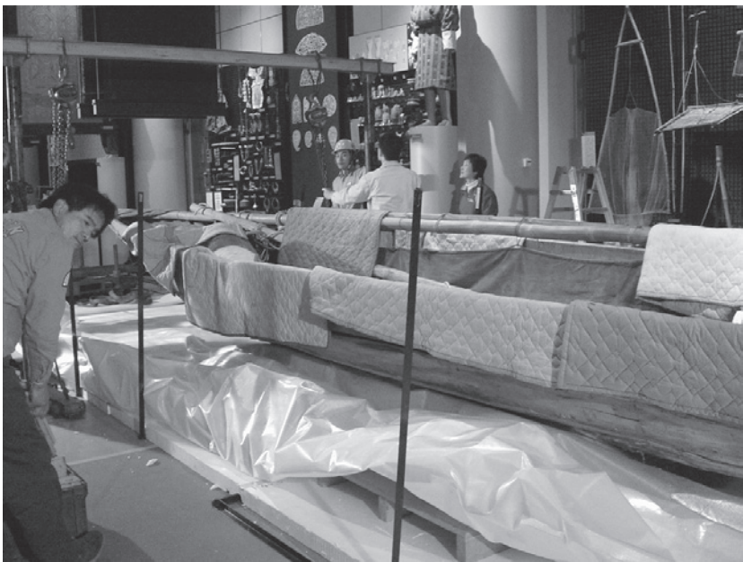
写真4 発泡スチロール板の上に、パレット、気密シートを敷いた後、船をおろす。
