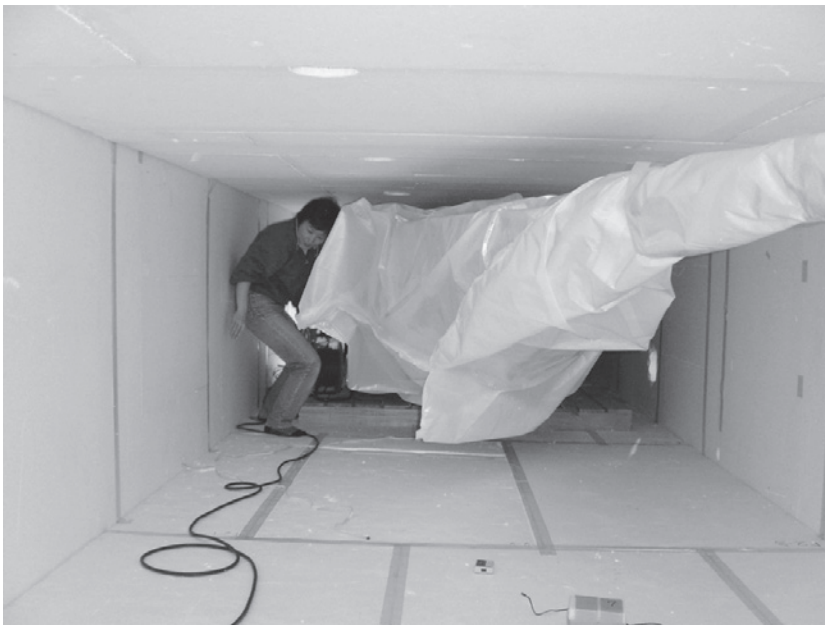
写真8 組み立てた断熱箱の内部。これから、温度モニタリング用の機材を設置する。
