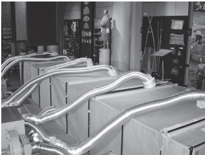
写真9 加温空気による殺虫処理装置の全容。
