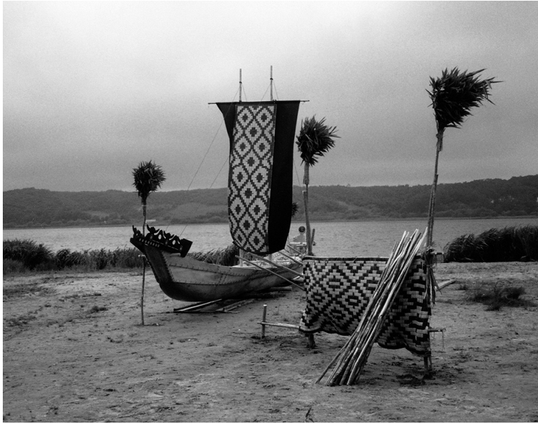
写真1 200年ぶりに復元されたアイヌのイタオマチブ（板綴り船）、釧路・タッコブ沼の岸辺（1989. 8撮影）
