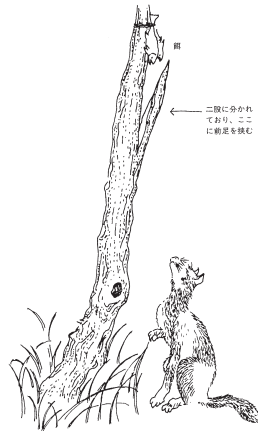
図39 キツネの足を挟む罠 (出利葉 2000: 27, 図7)
