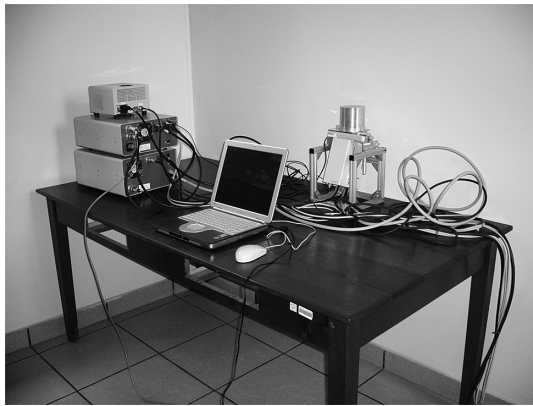
写真1 可搬型蛍光X線分析装置100FA (アワーズテック(株)製)
