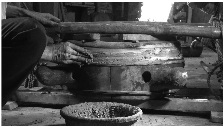
写真20 外鑄型と中鑄型の隙間に泥を塗る
