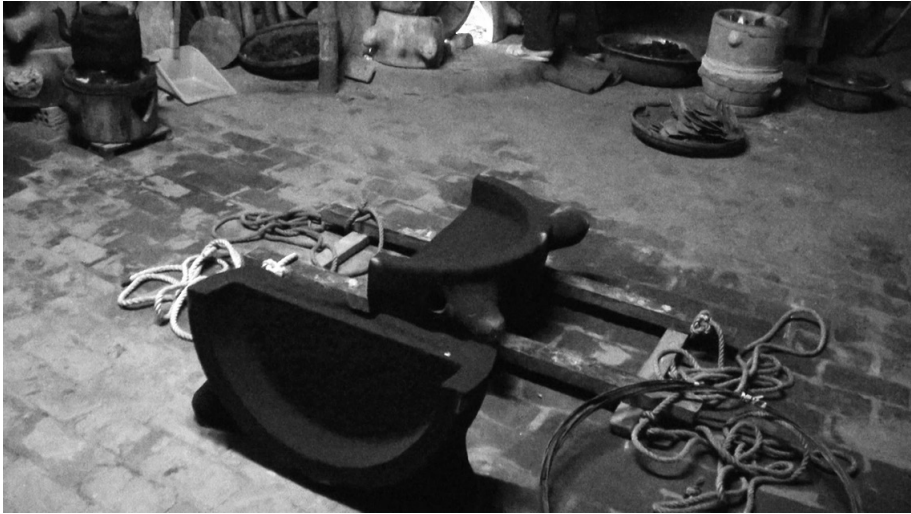
写真 17 ゴムを燃やして燻された外鑄型
