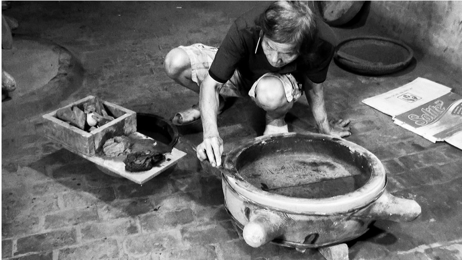
写真6 外鑄型の傷や隙間を粘土でふさぐ
