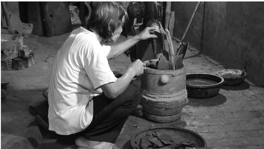
写真 18 ゴングの材料を坩堝にいれる
