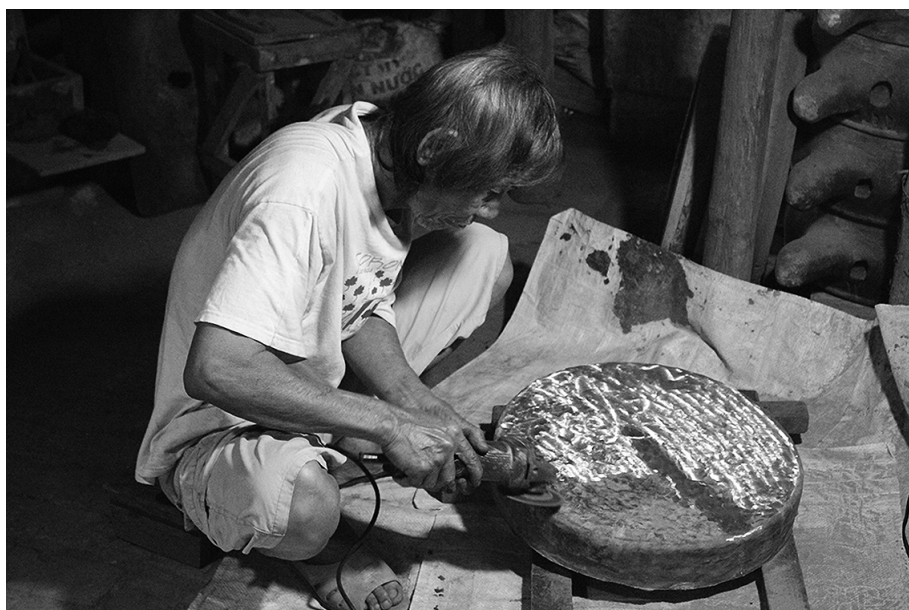
写真24 ゴングの表面をグラインダーで磨く
