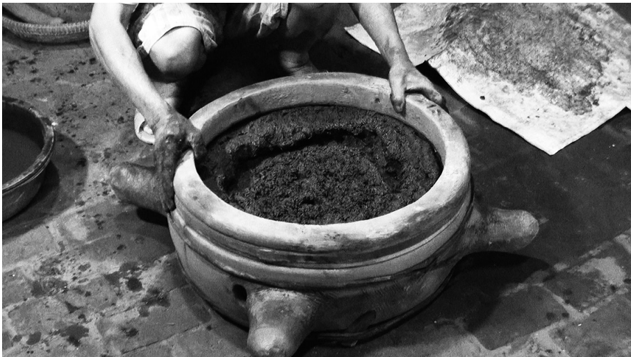
写真9 中鑄型を外鑄型の上に乗せる
