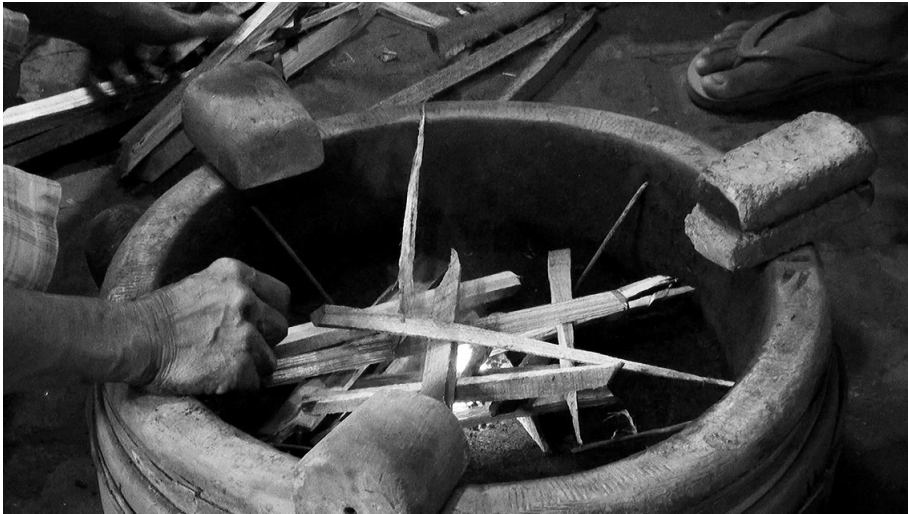
写真11 木片を燃やして原型を乾燥させる
