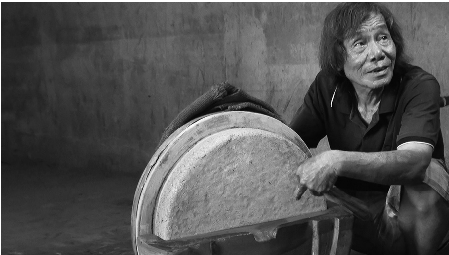
写真15 原型を外鑄型に合わせて、ゴングの厚みを確認する
