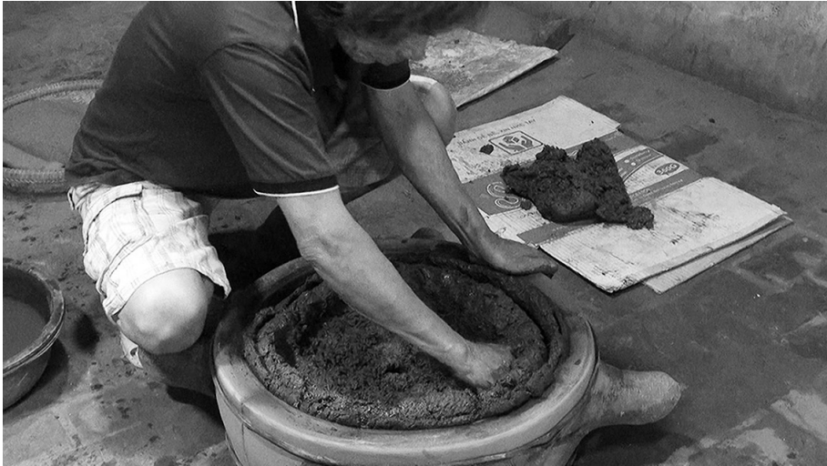
写真8 外鑄型に原型の材料を詰める
