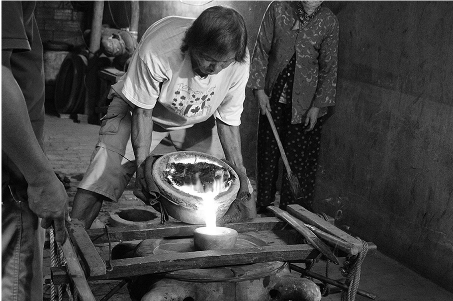
写真 22 溶かした金属を鑄型に流し込む
