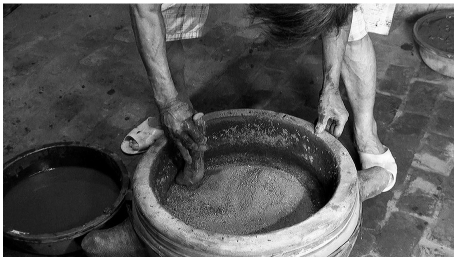
写真 10 砂土と籾殻を載せ木の棒で原型を固める
