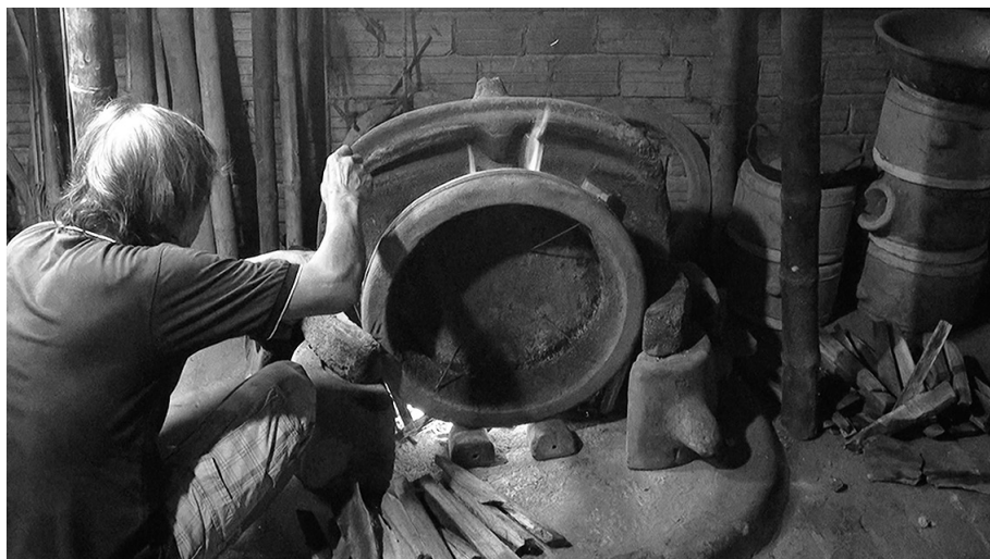
写真 13 原型を炉で焼成する
