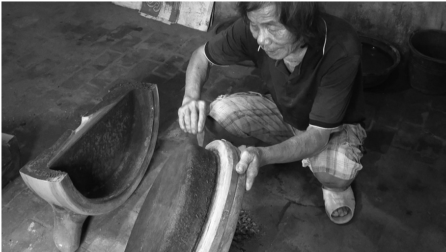
写真12 原型と中鑄型の際を削る
