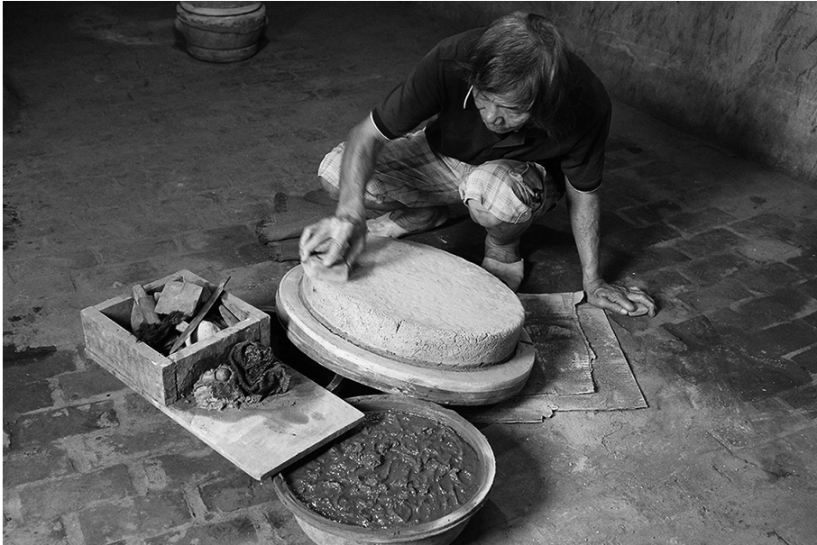
写真14 焼成した原型の表面を削る
