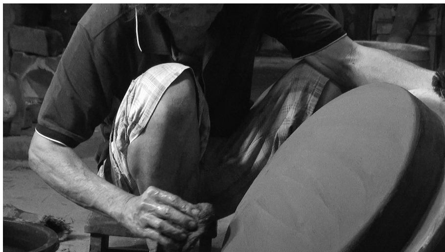
写真 16 原型の表面を滑らかにする
