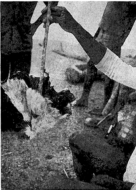
写真12 ふいごに用いる皮袋を製作している
