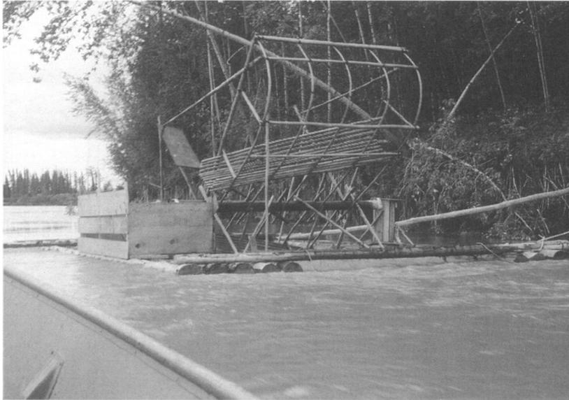
写真2 ユーコン川の川岸近くに設置されたフィッシュ・ホイール (撮影 井上敏昭)
