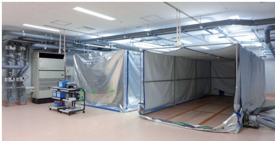
二酸化炭素処理および低酸素濃度処理のいずれにも対応可能な殺虫テント(各6.9m×2.8m×2.2m)(2014年2月14日、国立民族学博物館・多機能資料保管庫、園田直子撮影)。
