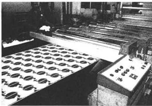
写真16 ローラー・プリントによるアフリカン・プリントの 捺染工程（カメルーン、ドゥアラ：2005年）
