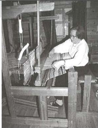
写真1 複合単式番目綜統型の開口具をと もなった枠機(高機)によるサーミ人の機織 り(ノルウェー、マンダレン・1993年)
