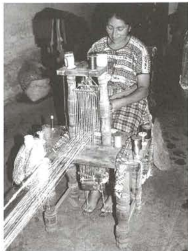
図2 トトニカパンの腰機の構造 a-釘(タテ糸間接保持具)、b-鉤(タテ糸保持具)、c-腰当、d-布巻き棒、e-番目綜統、f-口クロ、g-錘り(鉛板)、h-踏み木、i-筵
