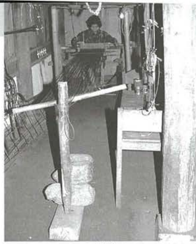
写真4 複合単式番目綜統型の開口具をともな った錘り機によるミナンカバウ人の機織り（イ ンドネシア、スマトラ島、パヤクンプ：1988年）
