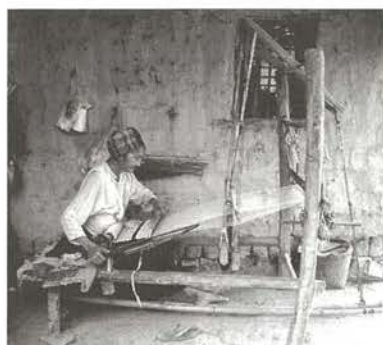
写真5 複式番目綜統型の開口具をともなった杵機(高機)による早傣族の機織り(中国、雲南省瑞麗県允悶村:1996年)
