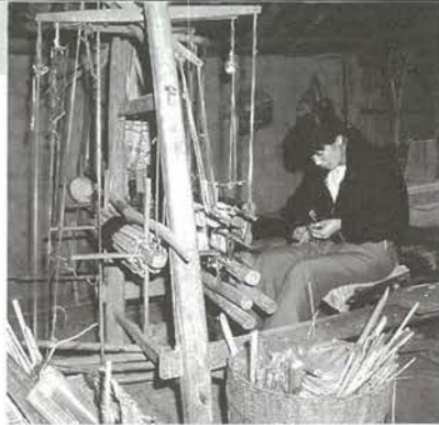
写真6 複式番目綜統型の開口具をともなった杵機(高機)による早傣族の機織り(中国、雲南省潞西県芒黑村:1996年)
