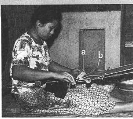
写真3 単式輪状綜統型（綜統・開口保持具可動式）の開口具をともなった腰機による機織り（インドネシア、バリ島トウンガナン村・1981年）
