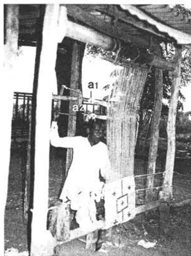
写真8 複式輪状綜統型(綜統可動式)の開口具をともなった枠機によるインド人の機織り(インド、マディヤプラデッシュ州:1979年)a1-輪状綜統、a2-輪状綜統
