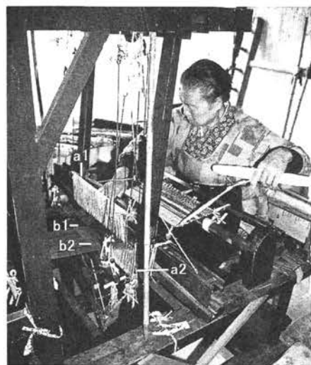
写真7 複合単式輪状綜統型(綜統・開口保持具可動式)の開口具をともなった高機による機織り(長野県原村:1996年)a1~a2-輪状綜統、b1~b2-開口保持具
