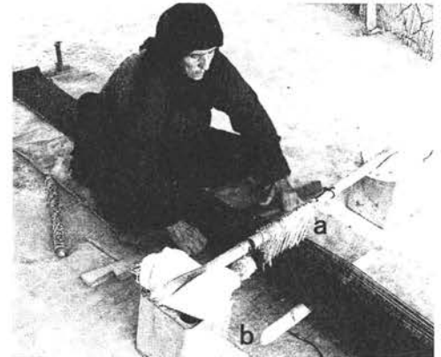
写真6 単式輪状綜統型(綜統固定・開口保持具可動式)の開口具をともなった地機によるバドゥイン人の機織り(シリア、アル・サハ:2004年)
