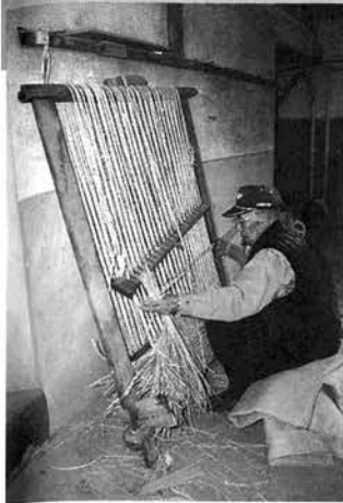
写真9 日本の傾斜式枠機（ムシロ機）による機織り（長野県原村：1996年）
