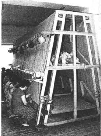
写真4 アゼルバイジャン人の傾斜式枠機による機織り(アゼルバイジャン、バクー:2004年)
