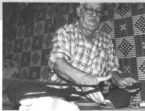
写真6 シリア人の回転板綜統をそなえた地機による機織り（シリア、ダマスカス：2004年）
