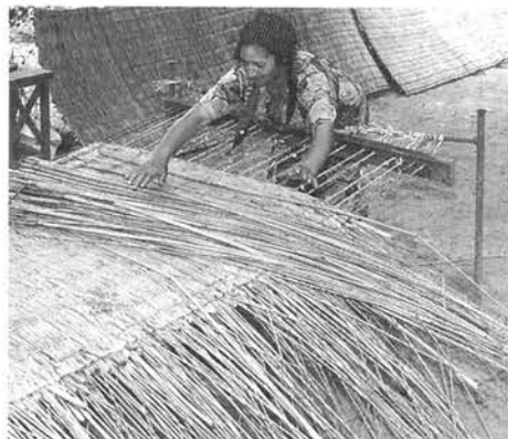
写真9 アゼルバイジャン人の無綜統の地機によるゴザ織り（アゼルバイジャン、サトルバ村：2004年）
