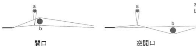
図2 輪状綜統固定式地機のタテ糸の開口と逆開口
