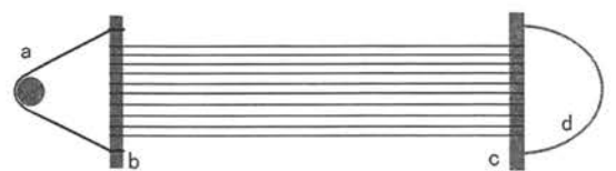
図2B 垂直に設置されたタテ糸間接保持棒によってタテ糸を固定する保持方式 a-タテ糸間接保持棒、b-先端棒、c-布巻き棒（整経方式が平整経式の場合）、あるいは手元棒（整経方式が結節輪状整経式の場合）、d-腰当
