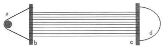
図2B 垂直に設置されたタテ糸間接保持棒によってタテ糸を固定する保持方式 a-タテ糸間接保持棒、b-先端棒、c-布巻き棒（整経方式が平整経式の場合）、あるいは手元棒（整経方式が結節輪状整経式の場合）、d-腰当
