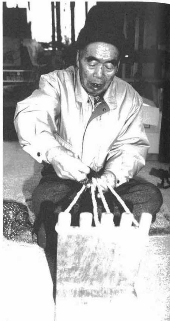
写真2 手機（草履台）による草履づくり（長野県、原村：1996年）
