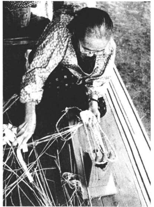
写真4 手織（ワラジ台）によるワラジづくり （八丈島、榎立：1987年）
