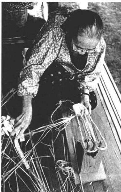
写真2 手機による機織り(八丈島、榎立:1987年)
