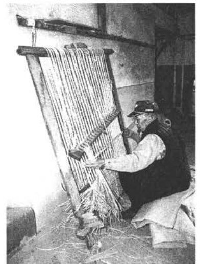
開孔棒綜統機(筵機)によるムシロ織り(長野県原村:1996年)
