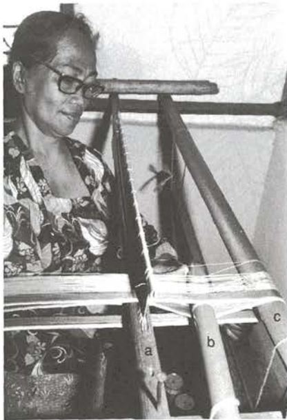
ブギス人による擬似輪状整経（インドネシア、スラウエシ島ドンガラ：1976年）
