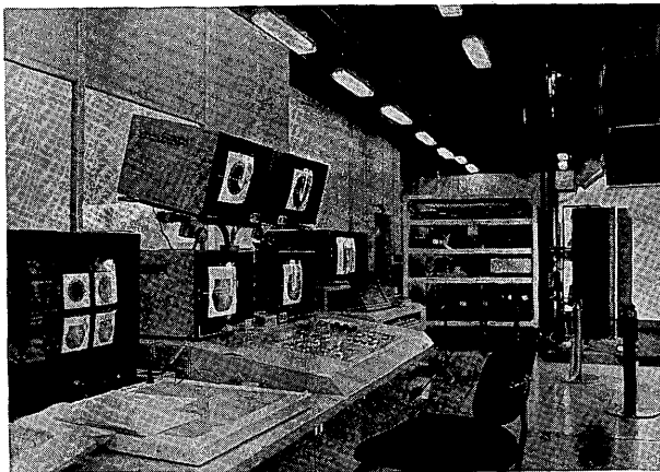
写真1 標本画像自動処理装置 （左より、画像ディスプレイ、モニター・操作卓、画像入力部）
