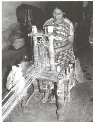
写真2 複合単式番目綜統型の開口具をともなった腰機によるケクチ人の機織り(ゲアテマラ、トトニカパン・2000年)
