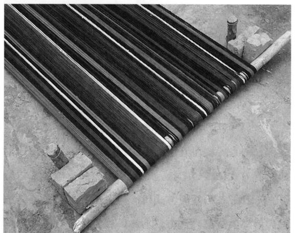
写真5 レンガと杭による経糸保持棒（横木）の設置方式
