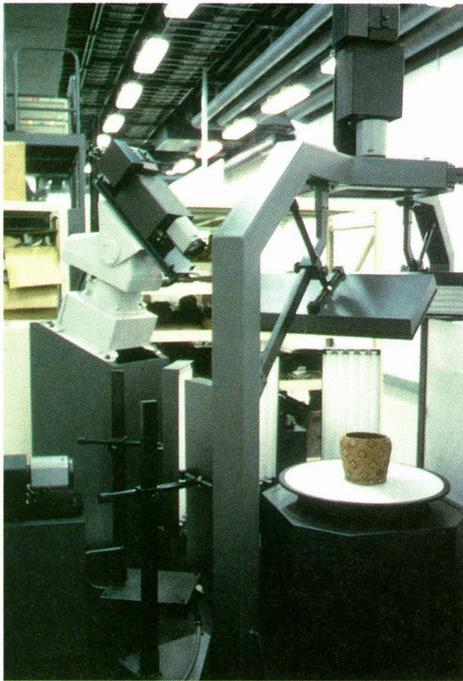
小型標本資料用の画像撮影装置。中央に直径60cmのターンテーブルがあり、そこに標本資料を置く。上に平面図を撮るカメラ、ターンテーブル正面には正面図を撮るカメラ、斜め上には鳥瞰図を撮るカメラがあり、正面図を撮ってターンテーブルをまわすと側面図も撮れる。このようにして、この載物台に乗せられる大きさの標本は1点1点、画像を撮影することができる。
