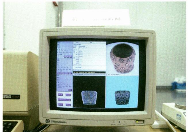
標本資料の3次元座標値を計測する装置。小さな載物台の上に髪飾りなどの標本資料を置くと、台が回転するとともに、台の正面に置かれた装置から赤いレーザービームが標本資料に照射される。標本資料の上、レーザービームがあたって赤く輝く部分を、レーザービームを照射する方向とは別の方向からCCDカメラで撮影し、その部分の3次元座標値を計算するという仕掛けである。載物台を細かい刻みで回転させる都度、3次元座標値を計算するため、結果として、標本資料の全周についての3次元座標値が求まるわけである。そのデータを3次元CGのソフトに与えてやれば、いろいろな方向から見た標本資料の外形を再生することができる。
